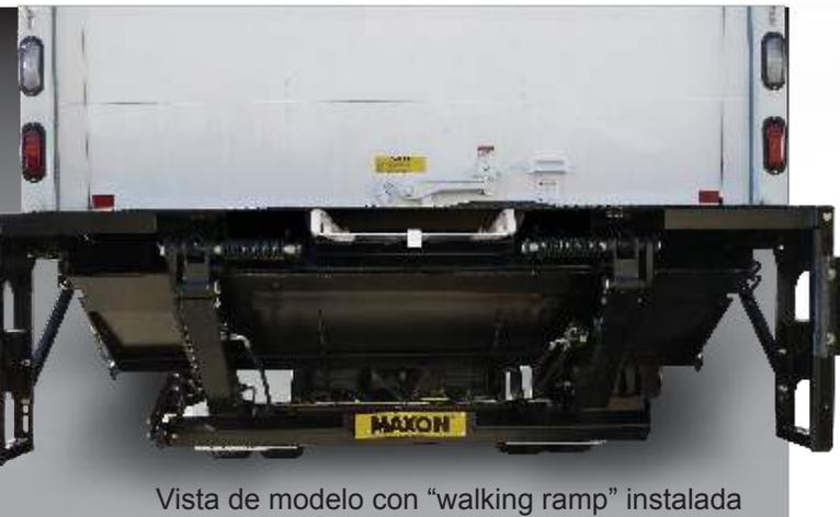
Vista de modelo con "walking ramp" instalada
